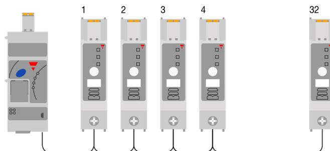
Wenn ein RG..N ersetzt wird oder Änderungen an der NRG-Bus-Kette vorgenommen werden, müssen die RG..Ns erneut adressiert werden. Führen Sie die folgenden Schritte aus, um die RG..Ns in der NRG-Bus-Kette manuell neu zu adressieren. Alternativ kann die automatische Adressierung mit einem "SDO" -Befehl erfolgen (weitere Informationen finden Sie im NRG EtherCAT-Benutzerhandbuch).
