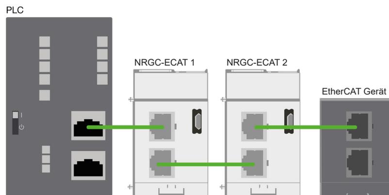
**Abb. 3** Beispiel einer Leitungskonfiguration des NRGC-ECAT mit weiteren EtherCAT-Geräten und dem Regler.
